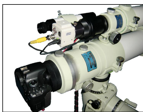
高感度カメラにより、微動雲台を使用せずシンプルにまとめた例
